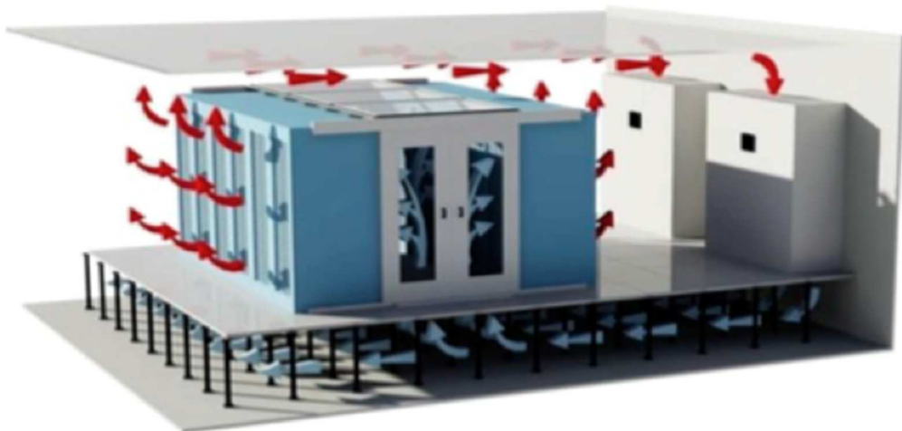
Figura 3. 5 – Confinamento de Corredor Frio.
